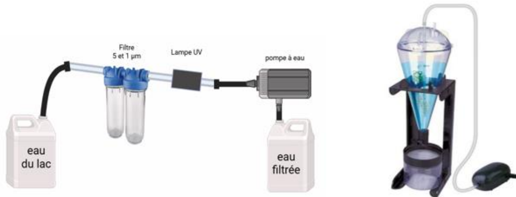
Figure 8 : Améliorations du protocole après visite des écloseries de bivalves en Bretagne : optimisation du système de filtration de l'eau du lac et contenant pour l'élevage des larves de type batch (fond conique) avec un bullage par le bas afin qui permet d'éviter les zones sans brassage.
